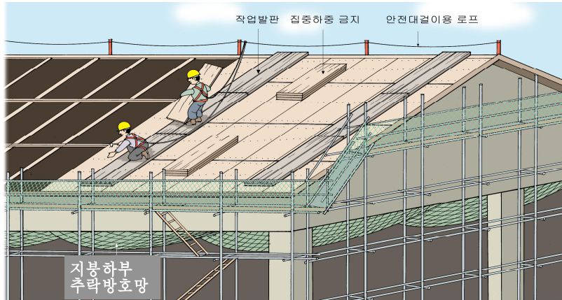
<그림 6> 경사진 지붕 안전시설 설치(예)
